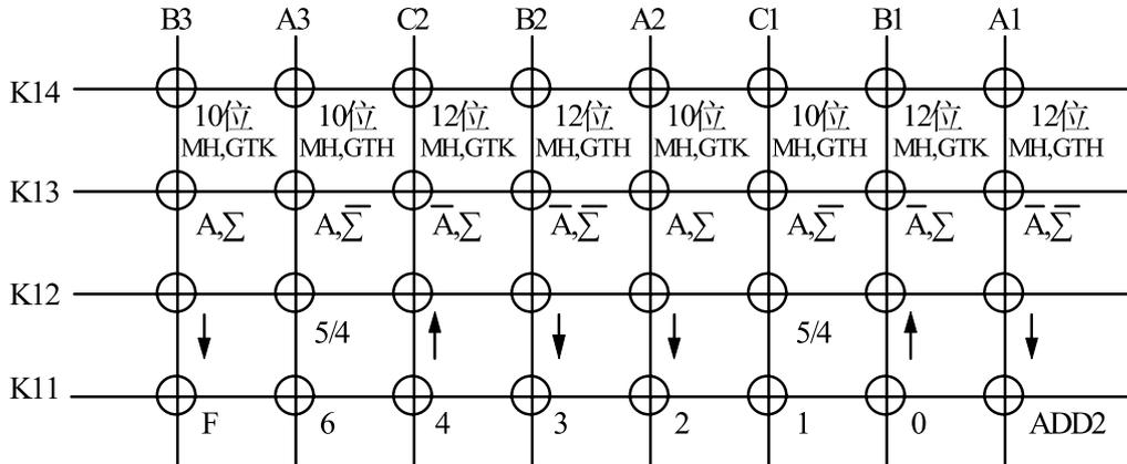
K14: 运算位数和存储保留状态选择, 当自动断电或按下 OFF 键时: 存储保留 (MH); 存储消除 (MK); GT 存储保留 (GTH); GT 存储消除 (GTK)。
